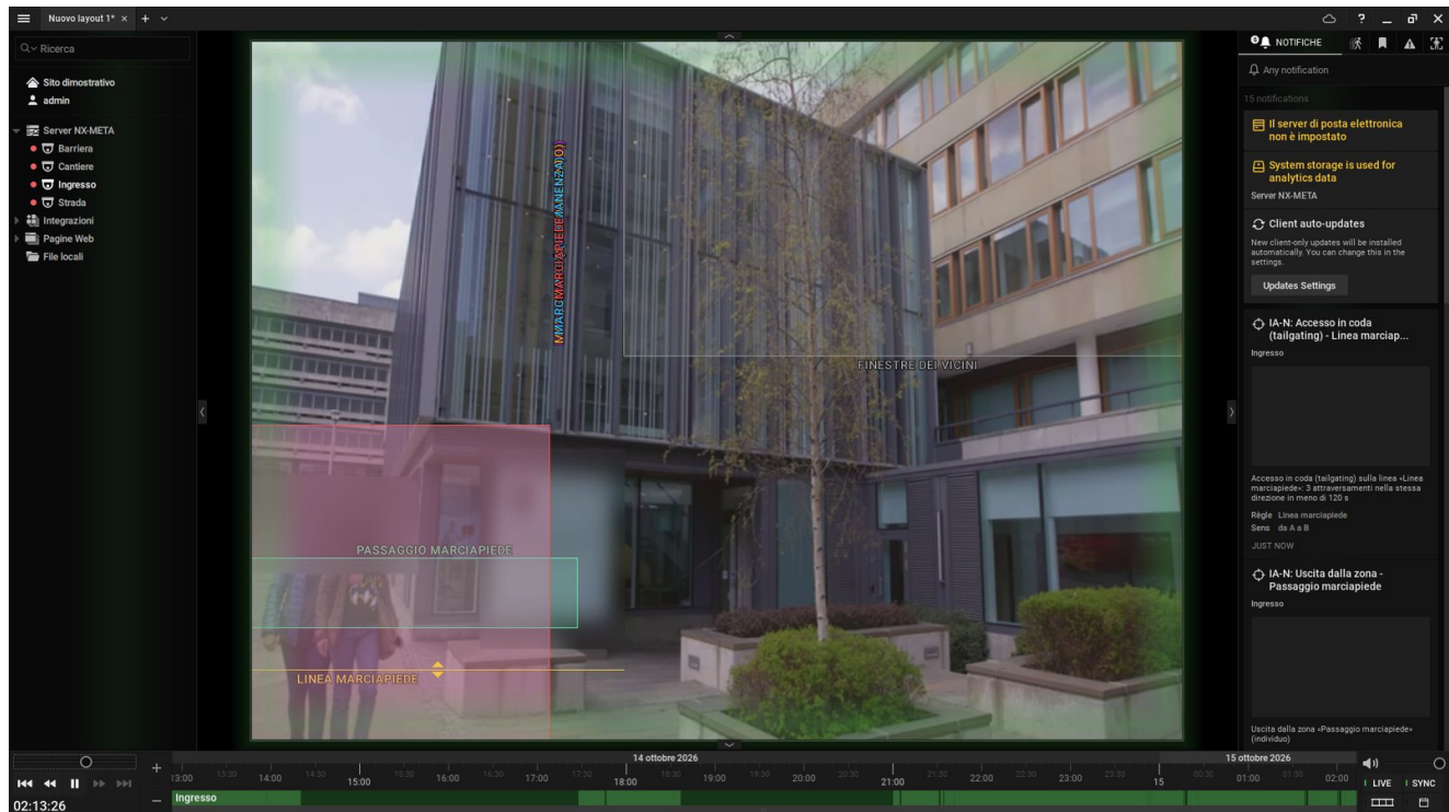
Schermata 1 — Allarmi IA-N in diretta: notifiche del VMS nel pannello destro (tipo, zona, telecamera, miniatura, testo dell'allarme).
