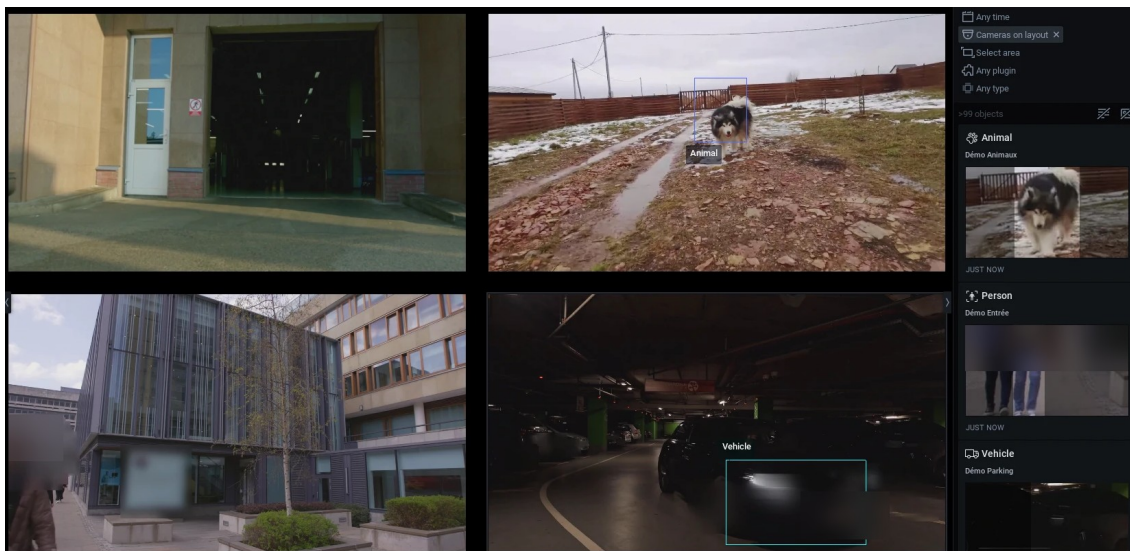
Captura real del cliente del VMS (cliente en inglés): recuadros «Animal» y «Vehicle», lista de objetos a la derecha con los filtros «Any plugin» y «Any type». Caras y matrículas difuminadas.
