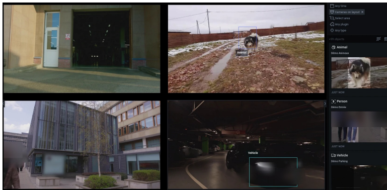
Capture réelle du client Nx (client en anglais) : gamme Détection, rectangles « Animal » et « Vehicle », liste des objets à droite. Visages et plaques floutés.
