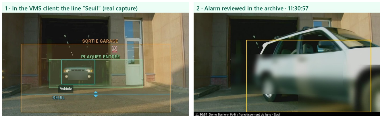
„Démonstration Barrière“: Linie „Seuil“ auf dem Boden vor der Garage, Fahrzeuge, beide Richtungen (Doppelpfeil in der Mitte der Linie). Alarm „IA-N: Linienüberschreitung - Seuil“. Aufgenommen mit dem Plugin auf Französisch.
