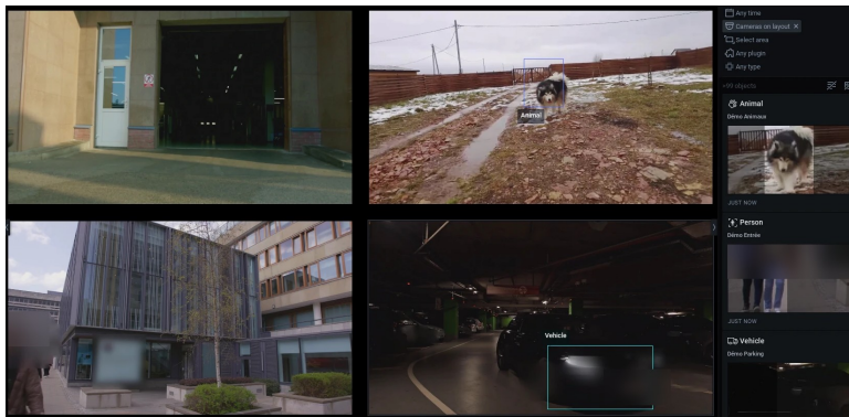
Cattura reale del client del VMS (client in inglese): gamma Rilevamento, riquadri «Animal» e «Vehicle», elenco degli oggetti (scheda «Objects») a destra. Volti e targhe sfocati.
